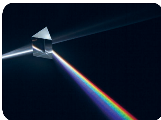
Luz decomposta em suas cores por um prisma.
