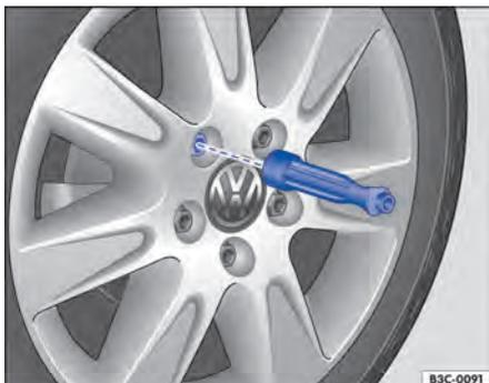
Fig. 210 Troca de roda: desaparafusar os parafusos de roda com o punho da chave de fenda.
