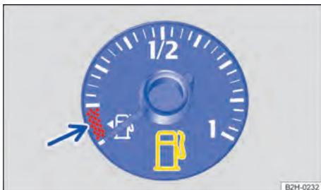
Fig. 11 Indicador do nível de combustível no instrumento combinado analógico.
