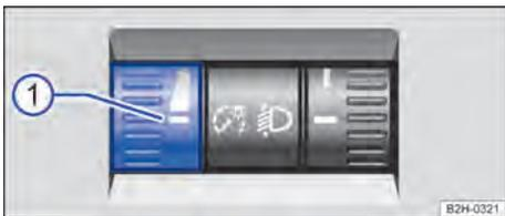
**Fig. 74** Ao lado do volante: regulador da regulação da iluminação dos instrumentos e dos interruptores.
