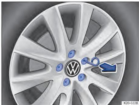
Fig. 192 Remover as capas de cobertura dos parafusos de roda.
