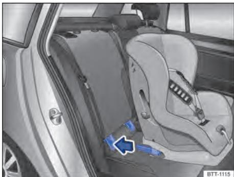
**Fig. 38** Representação esquemática: instalar a cadeira de criança ISOFIX com os braços de apoio.
