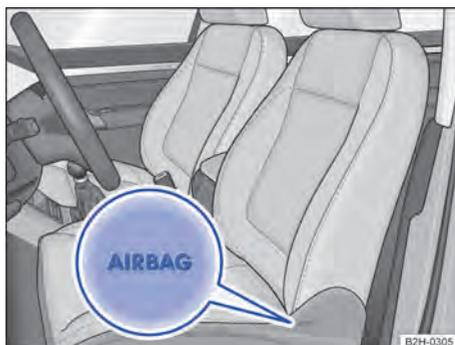
Fig. 32 Na lateral no banco dianteiro: local de instalação do airbag para cabeça e laterais combinado (variante 1).
