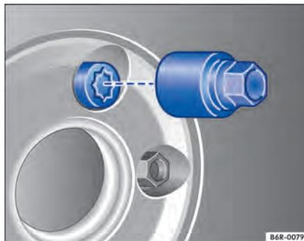
Fig. 194 Troca de roda: parafusos de roda antifurto e adaptador.
