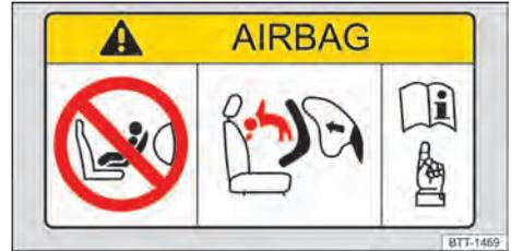
Fig. 35 Representação esquemática: etiqueta do airbag no para-sol.
