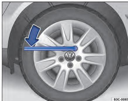
Fig. 193 Troca de roda: afrouxar os parafusos de roda.
