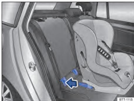
**Fig. 40** Representação esquemática: instalar a cadeira de criança ISOFIX com os braços de apoio.
