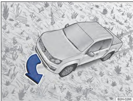
Fig. 102 Representação esquemática: dirigir na linha de inclinação.
