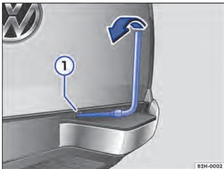
Fig. 196 Controlar a corda de elevação com o guincho.
