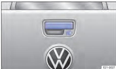
Fig. 49 Na tampa do compartimento de carga: alça para abrir a tampa do compartimento de carga.
