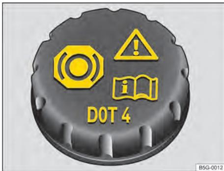
**Fig. 182** No compartimento do motor: tampa do reservatório do fluido de freio.
