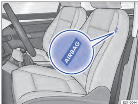
**Fig. 33** Na lateral no banco dianteiro: local de instalação do airbag para cabeça e laterais combinado (variante 2).
