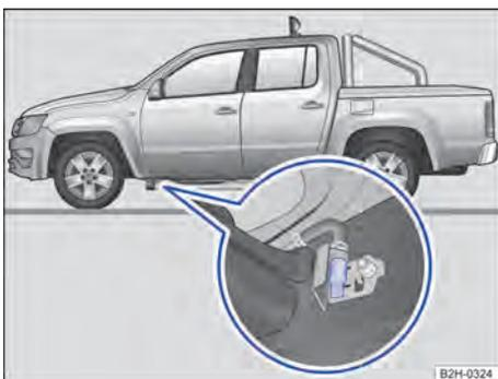
**Fig. 134** Na parte inferior do veículo, na longarina: bocal de drenagem do filtro do óleo diesel (dependendo da versão).
