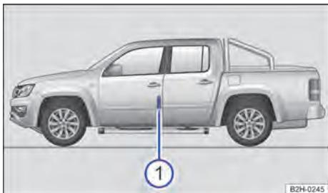
**Fig. 188** Na porta do condutor: etiqueta de pressão dos pneus (alternativamente no lado interno da portinhola do tanque).
