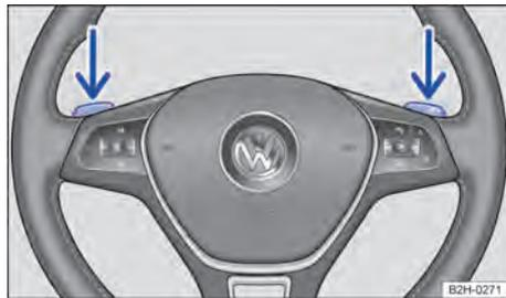
**Fig. 94** Volante com seletores basculantes do Tiptronic.
