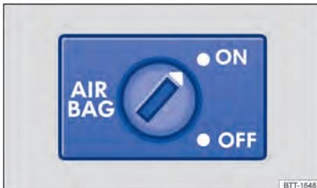
Fig. 30 Na parte frontal no lado do passageiro dianteiro: interruptor acionado pela chave para desativar e ativar o airbag frontal do passageiro dianteiro.
