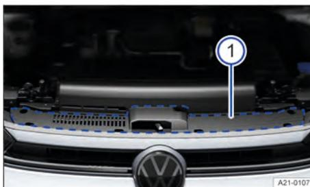
**Fig. 176** Local da colocação do adesivo da norma para óleo para motores e viscosidade de óleo para motores (representação esquemática).
