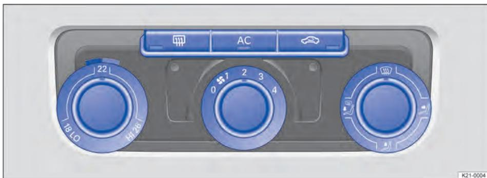
Fig. 84 No painel de instrumentos: elementos de comando do Climatic.
