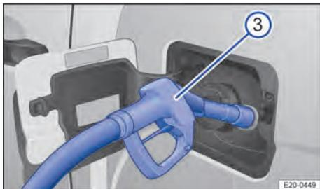
**Fig. 137** Reabastecer AdBlue com a bomba.
