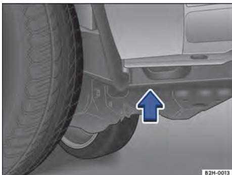
**Fig. 205** Pelo lado: ponto de apoio dianteiro do macaco.
