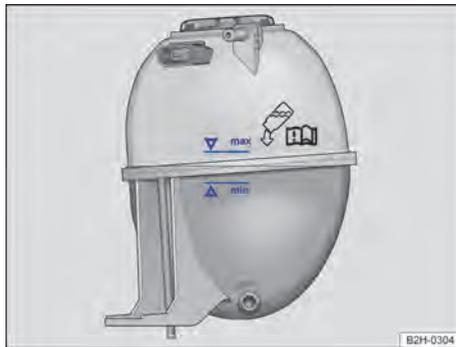
Fig. 180 No compartimento do motor: marca no reservatório de expansão do líquido de arrefecimento do motor (representação esquemática).
