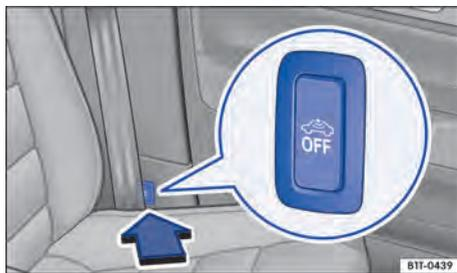
**Fig. 48** Ao lado do banco do condutor: botão para desligar o monitoramento do interior do veículo e o alarme antirrebocagem.
