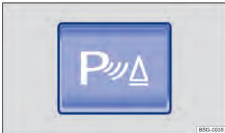
**Fig. 108** No console central: botão para ligar ou desligar o auxílio de estacionamento (depende da versão).
