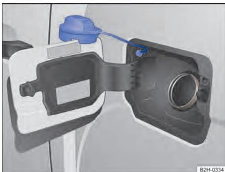
Fig. 133 No lado esquerdo do veículo: portinhola do tanque com tampa do tanque aberta.
