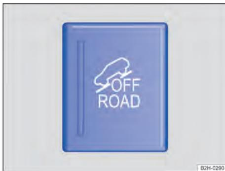
**Fig. 97** No console central: botão para ligar e desligar a função off-road manualmente.
