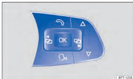
Fig. 15 No volante multifunções: botões para operação dos menus no instrumento combinado.
