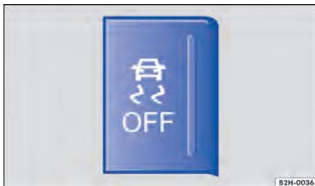
Fig. 112 No controle central: botão para desligar e ligar o ASR manualmente.
