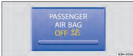
**Fig. 27** Na parte superior do console central: luz de controle para o airbag frontal do passageiro dianteiro desligado.
