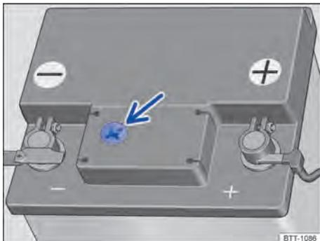
**Fig. 183** Visor no lado superior da bateria do veículo 12 V (representação esquemática).
