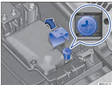
Fig. 164 No compartimento do motor, à esquerda: polo positivo do ponto de auxílio à partida.
