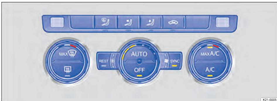
Fig. 85 No painel de instrumentos: elementos de comando do Climatronic.
