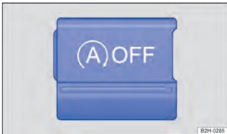
**Fig. 90** No console central: botão do sistema Start-Stop.
