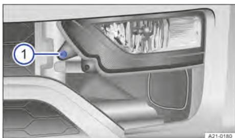
Fig. 148 No para-choque dianteiro: remover o farol.
