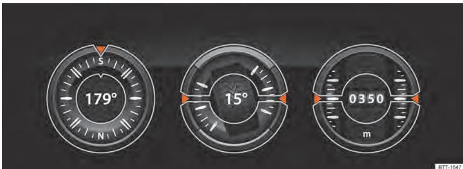
Fig. 99 Indicação no sistema Infotainment: indicação off-road.
