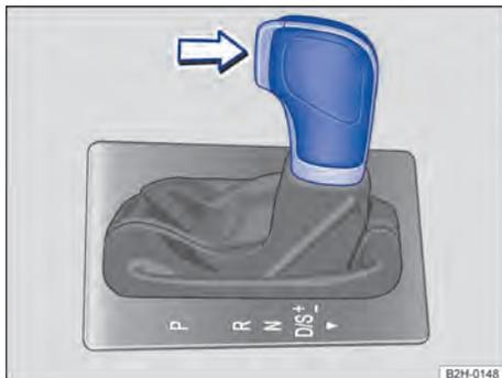
**Fig. 92** Volante à esquerda: alavanca seletora da transmissão automática com botão bloqueador (seta). Em veículos com direção à direita, a disposição dos elementos é espelhada.
