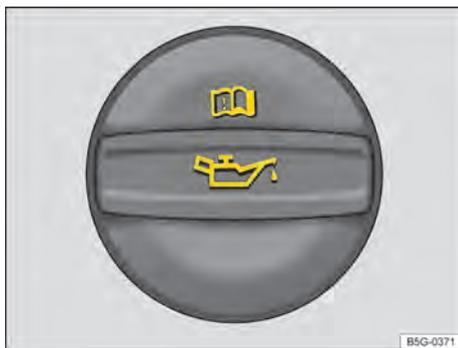
Fig. 178 No compartimento do motor: tampa da abertura para enchimento de óleo do motor (representação esquemática).
