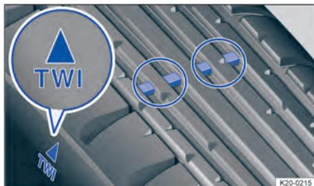
**Fig. 189** Perfil do pneu: indicador de desgaste.
