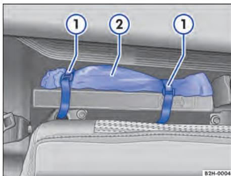
**Fig. 138** Atrás do encosto do banco traseiro: bolsa com ferramentas de bordo.
