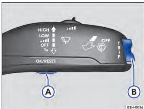
Fig. 14 Na alavanca do limpador de para-brisa: botões para operar os menus.
