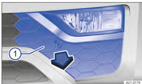
Fig. 147 Para-choque dianteiro: remover o protetor.
