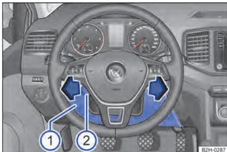
Fig. 160 No lado do condutor, veículos com direção à esquerda: caixa de fusíveis atrás do revestimento do painel de instrumentos.
