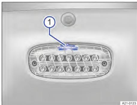
**Fig. 76** Sobre a tampa do compartimento de carga: interruptor da iluminação da capota rígida do compartimento de carga.
